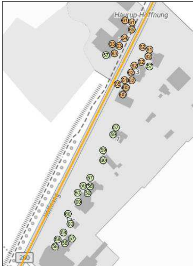
Abbildung 8: Fassadenpunkte L_{Night} B200 Haurup-Hoffnung Quelle: Ausschnitt aus dem Geoportal Umgebungslärm 24
