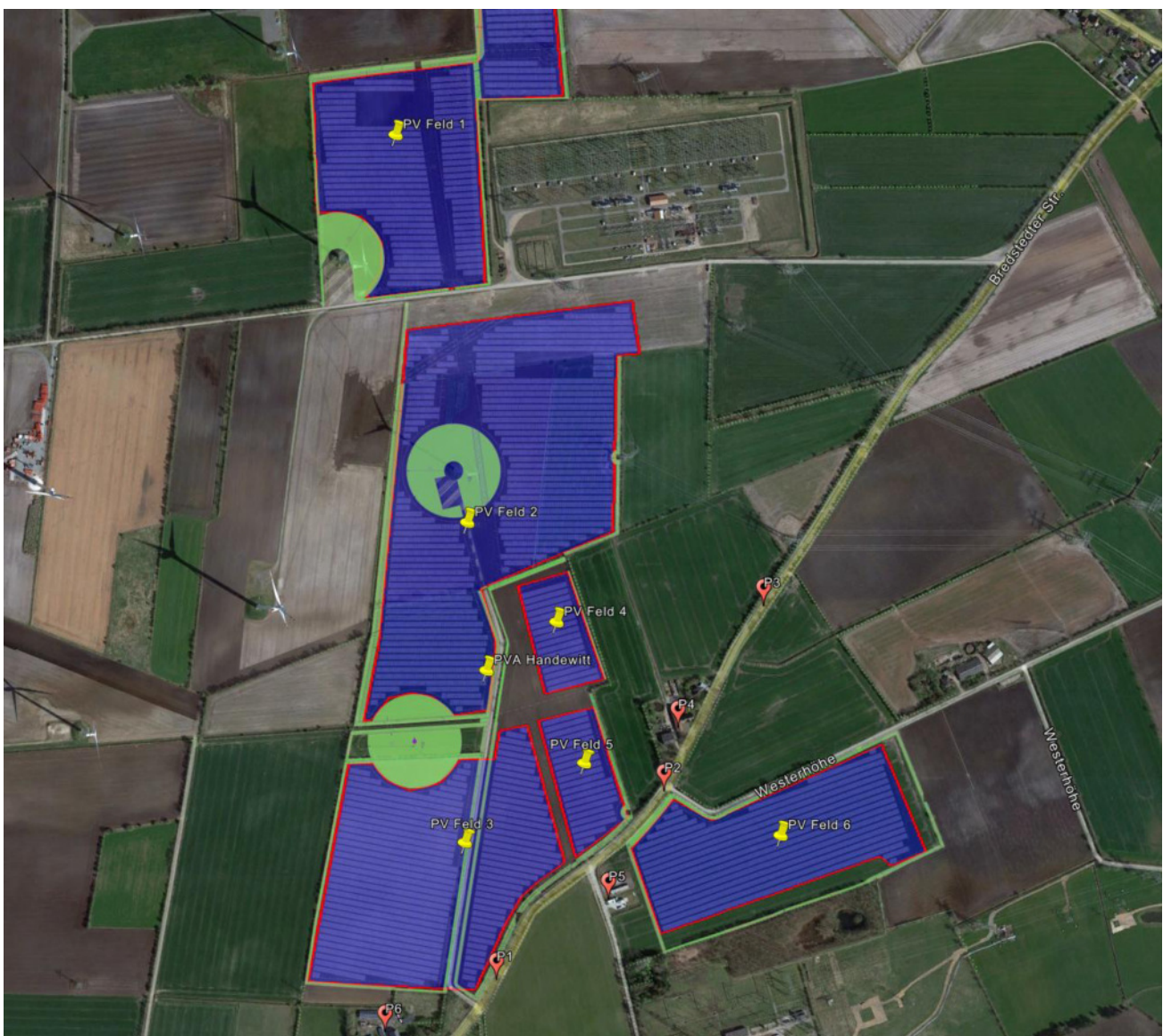
Bild 3.5.1: Exemplarisch gewählte Messpunkte für die Analyse der Reflexionen (Quelle: Google Earth/SolPEG)
